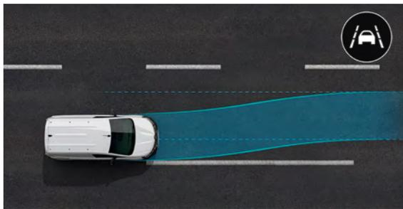
**Spurhalteassistent.** Bei Geschwindigkeiten zwischen 70 km/h und 160 km/h ist er aktiv und bringt Ihr Fahrzeug sicher zurück in die Spur, wenn Sie eine durchgezogene Linie oder eine gestrichelte Fahrbahnmarkierung überfahren, ohne zu blinken.
