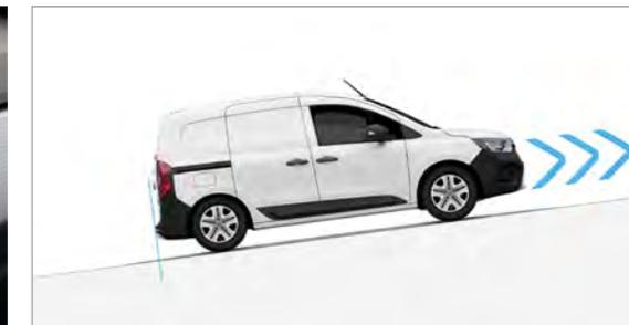
**Berganfahrhilfe.** Wird bei einer Steigung von über 3% aktiviert und hält den Bremsdruck noch 2 Sekunden aufrecht, wenn Sie den Fuß vom Bremspedal nehmen.
