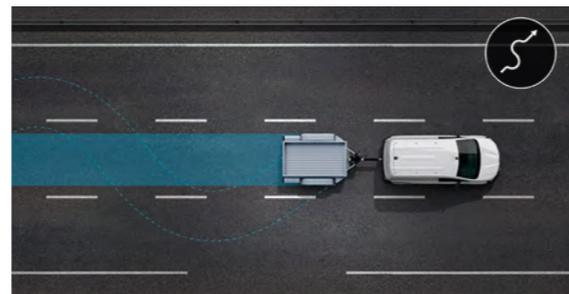
**Anhängerstabilitätskontrolle.** Die Anhängerstabilitätskontrolle ist ausschließlich für Fahrzeuge mit Anhängerkupplung bzw. Anhängervorbereitung erhältlich. Das System ist mit dem ESP gekoppelt und dient dazu, die Pendelbewegungen des Anhängers (max. 1.500 kg) unabhängig von der Geschwindigkeit zu verringern. Es verbessert die Richtungsstabilität bei Seitenwind oder mangelhaftem Fahrbahnzustand.
