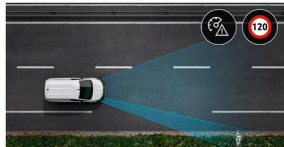
**Verkehrszeichenerkennung mit Geschwindigkeitswarner.** Eine Warnanzeige weist den Fahrer darauf hin, wenn die Geschwindigkeit des Fahrzeugs die zulässige Höchstgeschwindigkeit überschreitet.
