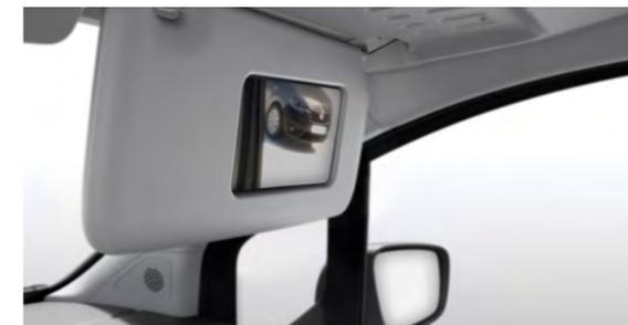
**Weitwinkel-Spiegel.** Ein großer, gewölbter Spiegel in der Sonnenblende auf der Beifahrerseite verbessert die seitliche Übersicht. Damit erkennt der Fahrer auch Fahrzeuge, die sich von rechts hinten nähern und von den anderen Spiegeln möglicherweise nicht erfasst werden.
