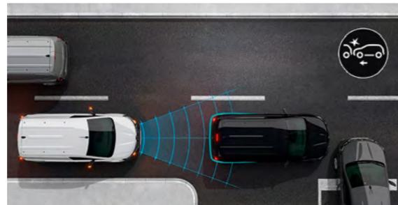
**Notbremsassistent.** Er erkennt Fahrzeuge, Fußgänger und Radfahrer, die sich Ihrem Fahrzeug von vorne oder seitlich nähern. Bei Gefahr leitet er eine Vollbremsung ein und macht so vor allem das Fahren in der Stadt bei Tag und Nacht sicherer für alle.
