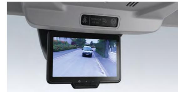
**Rear View Assist.** In der Ausführung mit verbleichten Hecktüren ersetzt ein Monitor den Rückspiegel. Auf dem fünf Zoll großen Display wird das Bild der Kamera am Heck angezeigt, sodass der Fahrer die Situation hinter dem Fahrzeug immer im Blick hat. Das erleichtert das Fahren und macht das Manövrieren entspannter.
