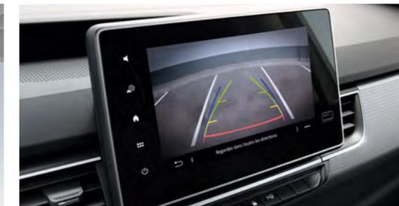
**Rückfahrkamera.** Sobald der Fahrer den Rückwärtsgang einlegt, überträgt die Rückfahrkamera eine deutliche Darstellung der Umgebung hinter dem Fahrzeug. Dieses Bild erscheint entweder auf dem elektronischen Rückspiegel oder im zentralen Easy Link Display. Dynamische Linien unterstützen beim Rückwärtsmanövrieren.
