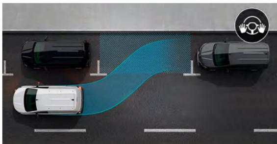
**Easy-Park-Assistent.** Erkennt einen passenden Parkplatz und lenkt das Fahrzeug selbstständig in die Lücke, wenn Sie das Fahrpedal betätigen.
