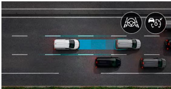
**Active Driver Assist.** Regelt die Geschwindigkeit unter Berücksichtigung der Verkehrssituation und der Sicherheitsabstände und sorgt dafür, dass Sie die Spur halten. Stoppt und startet bei zähfließendem Verkehr automatisch.
