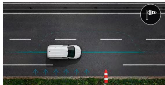
**Seitenwindassistent.** Wenn der Kangoo Rapid bei über 70 km/h von einer seitlichen Windböe erfasst oder von einem anderen Fahrzeug überholt wird, hält ihn dieser Assistent sicher in der Spur.
