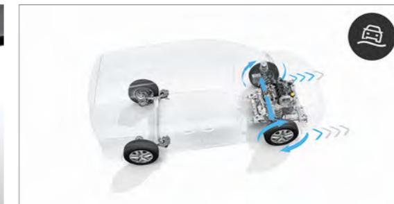
**Traktionskontrolle Extended Grip.** Unterstützt Sie, wenn Sie bei schlechtem Wetter oder auf rutschigem Untergrund unterwegs sind. Bis zu einem Tempo von 50 km/h verhindert sie zusammen mit der elektronischen Stabilitätskontrolle (ESP) ein Durchdrehen der Räder und sorgt für eine optimal verteilte Motorleistung.
