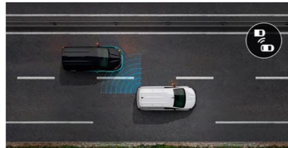
**Toter-Winkel-Warner.** Dieser Assistent ist bei Geschwindigkeiten zwischen 30 km/h und 140 km/h aktiv und macht das Abbiegen sicherer. Er warnt den Fahrer mit einem Leuchtsignal im Außenspiegel, wenn ein anderes Fahrzeug im toten Winkel auftaucht.
