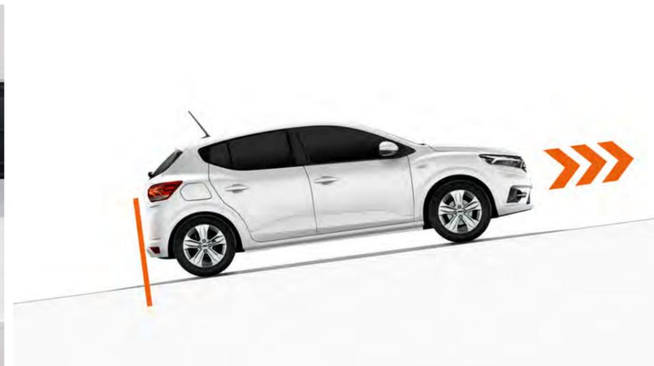
**Berganfahrhilfe.** Das Anfahren an einer Steigung wird mit diesem System nun kinderleicht. Es verhindert zuverlässig ein Zurückrollen, wenn Sie den Fuß von der Bremse nehmen.
