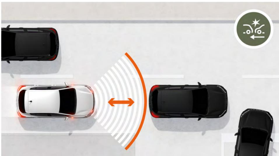
**Aktiver Notfall-Bremsassistent (AEBS).** Auch wenn Sie immer aufmerksam und konzentriert fahren – manche Situationen lassen sich kaum vorhersehen. Dann hilft der Aktive Notfall-Bremsassistent. Wenn das System die Gefahr einer Kollision erkennt und Sie nicht schnell genug reagieren, baut es die maximale Bremskraft auf und bringt Ihren Dacia Sandero sicher zum Halten.
