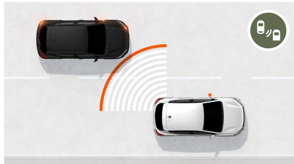
**Toter-Winkel-Warner.** Bei Spurwechseln oder beim Abbiegen warnt Sie der Toter-Winkel-Warner des Dacia Sandero vor einem Zusammenstoß, wenn seine Sensoren ein Fahrzeug registrieren, das neben oder seitlich hinter Ihnen fährt.
